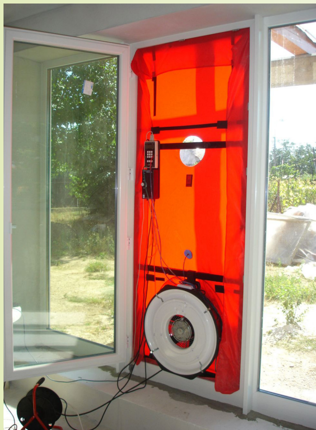
Obr.5 Meranie vzduchovej priepustnosti tzv. BlowerDoor test, foto: Vladimír Šimkovic.
