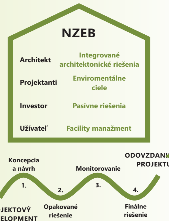
Obr. 4 Prehľad ID procesu. Tvorivý proces riešenia problémov (2) beží paralelne v čase s monitorovaním pokroku v súlade s cieľmi (3). Toto je zriedka priamočiary proces a jednotlivé fázy by mali byť otvorené tak dlho, kým sa všetky potrebné informácie začlenia do konečného návrhu.
